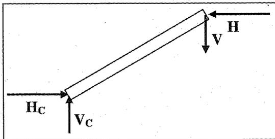
Eliminando la cerniera in C e sostituendola con le reazioni  $H_C$  e  $V_C$ , si possono scrivere le equazioni di equilibrio alla traslazione orizzontale e verticale:
