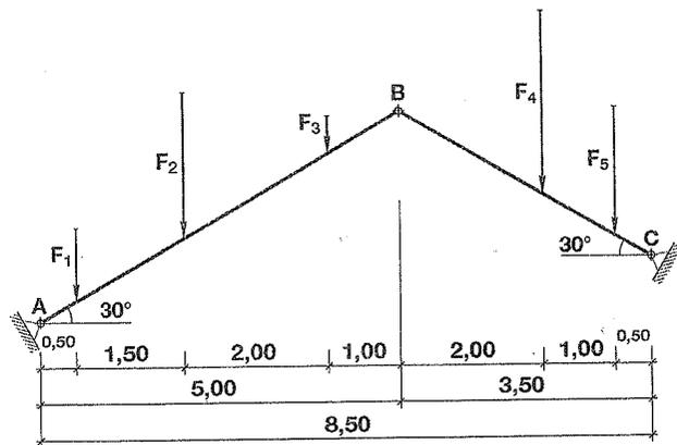
$[R_A \approx 8,50 \text{ kN}; \quad R_B \approx 4,60 \text{ kN}; \quad R_C \approx 9,60 \text{ kN}]$
