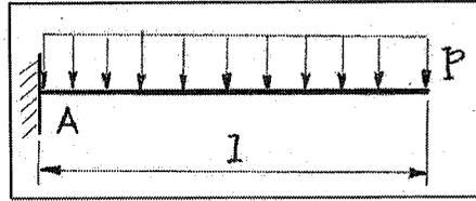
Ai soli fini del calcolo delle reazioni vincolari, si può sostituire il carico distribuito con la sua **RISULTANTE**:
