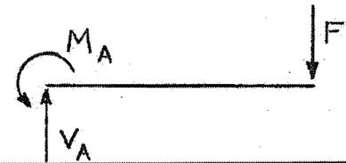
Non essendoci componenti orizzontali del carico, la reazione dell'incastro si riduce ad una forza verticale  $V_A$  e ad un momento  $M_A$  detto "Momento d'incastro".
