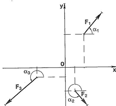
$[R = 8,56 \text{ kN}; \quad \alpha \approx 263^\circ,76]$
