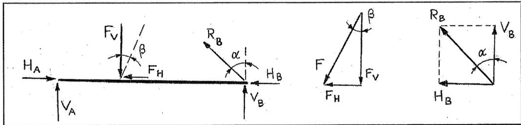
Le incognite sono apparentemente 4 ma, essendo nota la direzione di  $R_B$ , inclinata di  $\alpha$  rispetto alla verticale,  $H_B$  e  $V_B$  sono legate dalla relazione:
