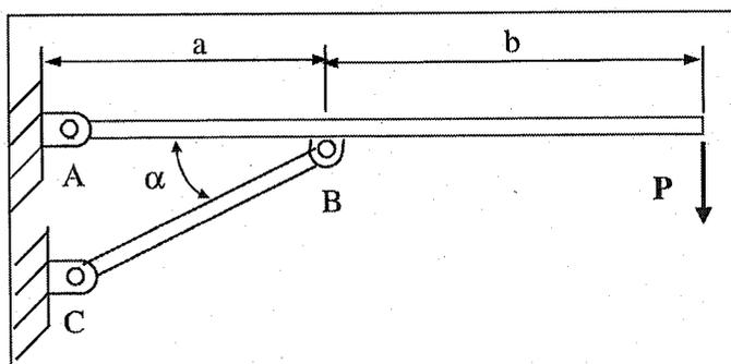
Struttura costituita da 2 travi collegate fra loro da una cerniera, nel punto B, che non interrompe la continuità materiale della trave orizzontale.
