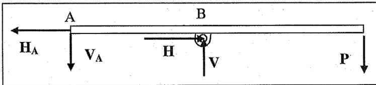
Eliminando la cerniera in A e sostituendola con le reazioni  $H_A$  e  $V_A$ , si possono scrivere le equazioni di equilibrio alla traslazione orizzontale e verticale:
