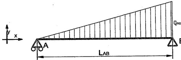
Come prima cosa si calcola il carico localizzato  $Q$ , equivalente al carico continuo applicato, e la sua posizione; sia  $L_{A1}$  la sua distanza dalla sezione A.
